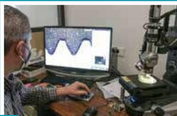
Le microscope numérique puissant (Zoom jusqu'à x2000) permet de recomposer les images en 3D.
